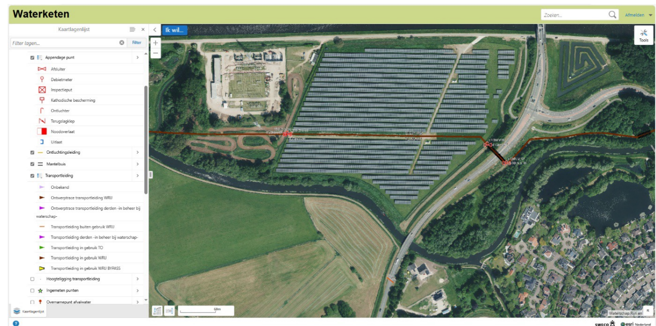
Voorbeeld van een zonneweide waarbij wél een strook is vrijgehouden om onderhoud aan de AWTL mogelijk te maken – bron afbeelding: waterschap Rijn en IJssel.
